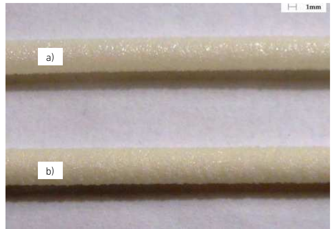
6. ábra. Gyártott habszerkezetek, a) 8052_6800 receptúra, b) 2003_6800 receptúra
