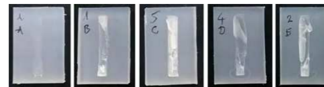
7. ábra: Jellegzetes töretfelületek az egyes fröccsöntési beállításokkal gyártott próbatetek esetén normál irányú tapadásvizsgálatnál
