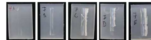
10. ábra: Jellegzetes töretfelületek az egyes fröccsöntési beállításokkal gyártott próbatetek esetén nyíró irányú tapadásvizsgálatnál
