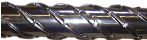
1. ábra. CRD (Chris Rauwendaal Dynamic mixer) keverős csiga kialakítása [5]
