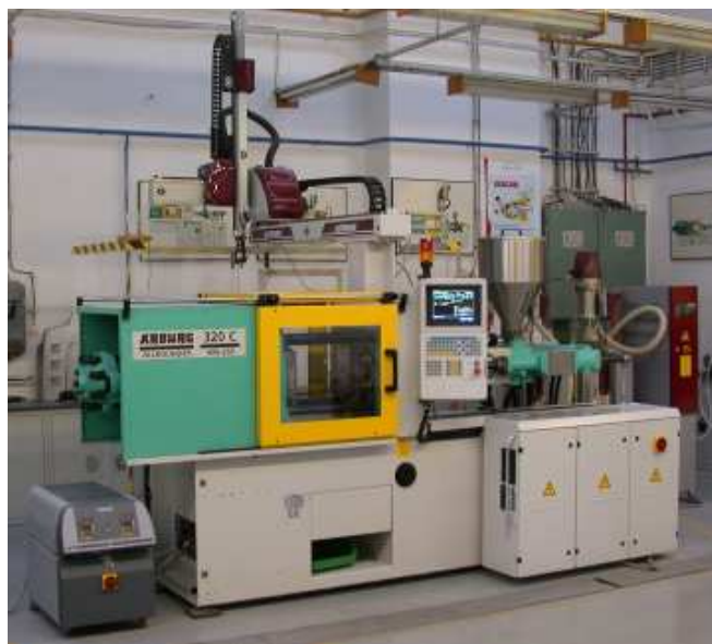
10. ábra. Tanszékünk fröccsöntőgépe (Arburg 320C 600-250) a kiegészítő berendezéseivel (Wittmann Tempro Plus 2/90 típusú temperáló, Wittmann W711C típusú robot, Wittmann D30-30/30-M szárazlevegős szárító, teljes kiépítésű Kistler nyomás- és hőmérő szenzorrendszer)
