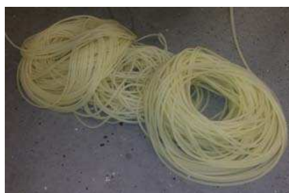
2. ábra. Extrúzióval folytonosan előállított TPS előgyártmány
