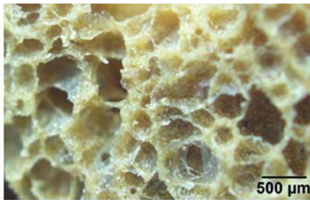
◀ 5. ábra: Az elkészített gumihabok keresztmetszeti felvételei
