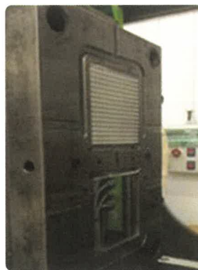
2. ábra: A fröccsöntő szerszám a behelyezett vázszerkezettel
