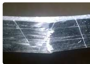
3. ábra. Tipikus húzott oldali törés, 4 pontos hajlítás
