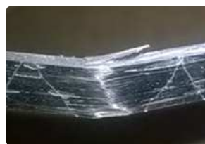
4. ábra. Tipikus nyomott oldali törés, 4 pontos hajlítás
