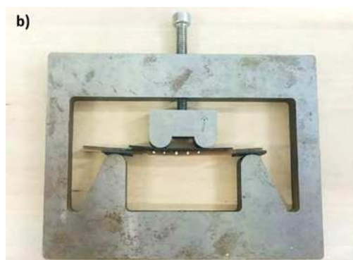
3. ábra. a) 4-pontos hajlítás elrendezés, b) Hajlítókeret próbatesttel
